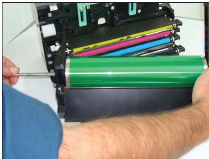
Ilustración 32. Inserción del eje desde lado engranaje.
