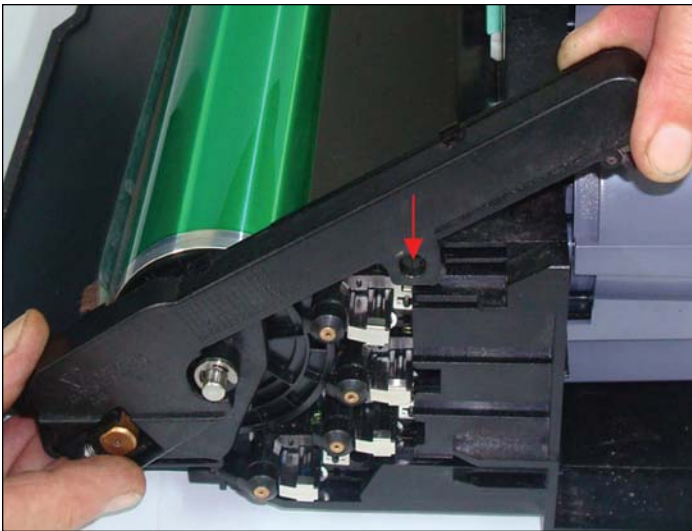
Ilustración 6. Desplazamiento del lateral.
