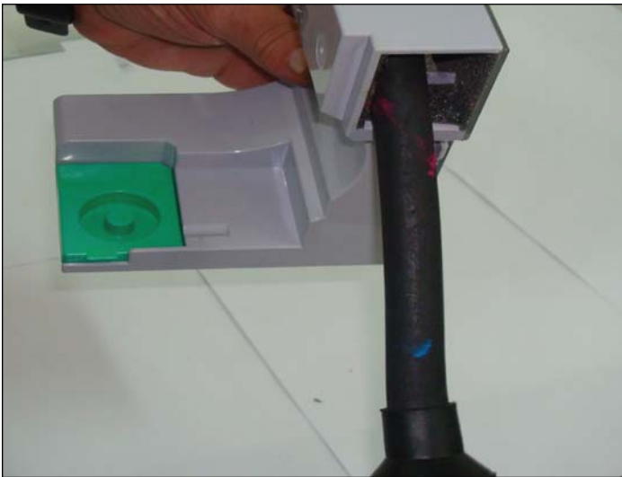
Ilustración 4. Aspiración del contenido de tóner residual.
