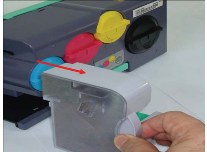
Ilustración 3. Retiro del compartimiento de Residuo.
