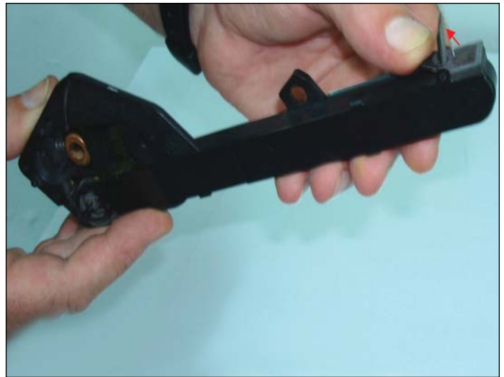
Ilustración 15. Lateral con sistema de transporte de toner.
