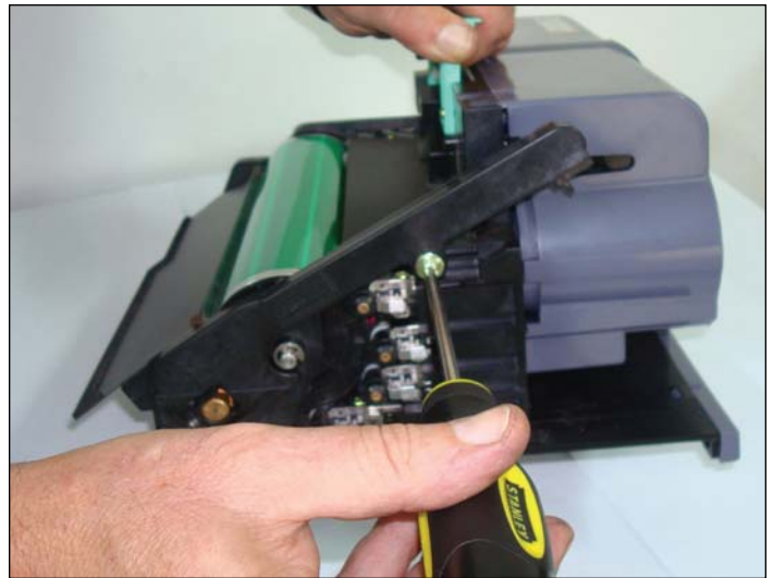
Ilustración 36. Atornillado del conjunto.
