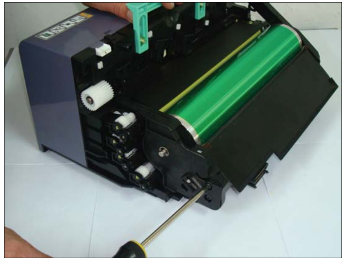
Ilustración 34. Fijación del lateral.
