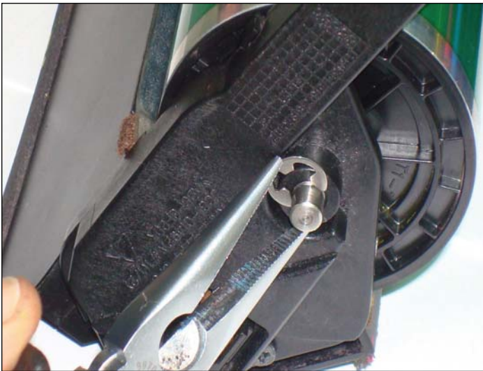
Ilustración 33. Colocación de la arandela de seguridad en el eje.
