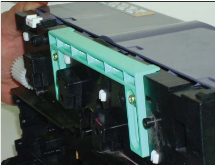
Ilustración 25. Destrabado de la Lengüeta izquierda.
