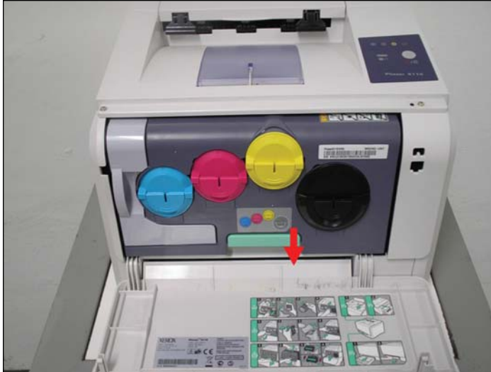
Ilustración 2. Acceso al Modulo de Imagen.
