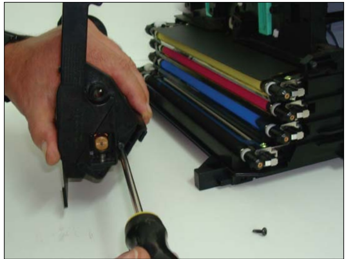
Ilustración 13. Desmontaje del lateral.
