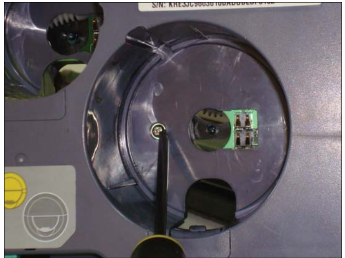
Ilustración 22. Tornillo Tapa Porta Cartuchos.
