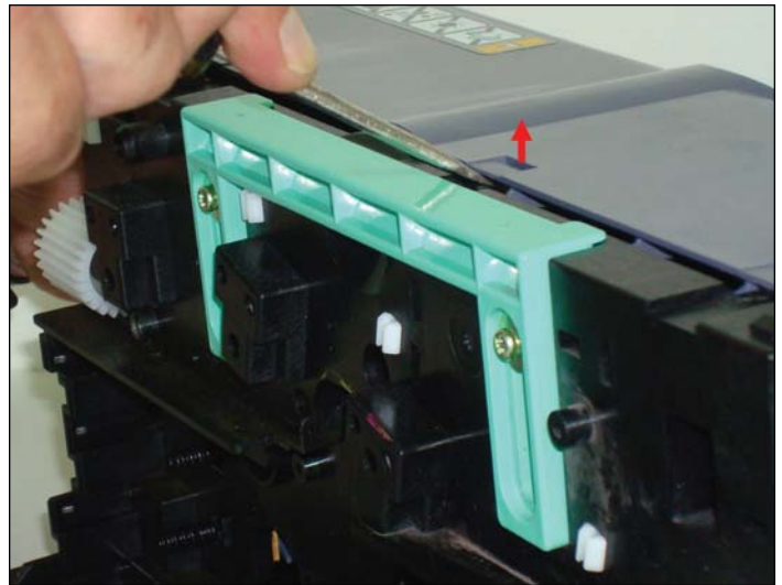
Ilustración 24. Destrabado Lengüeta central.
