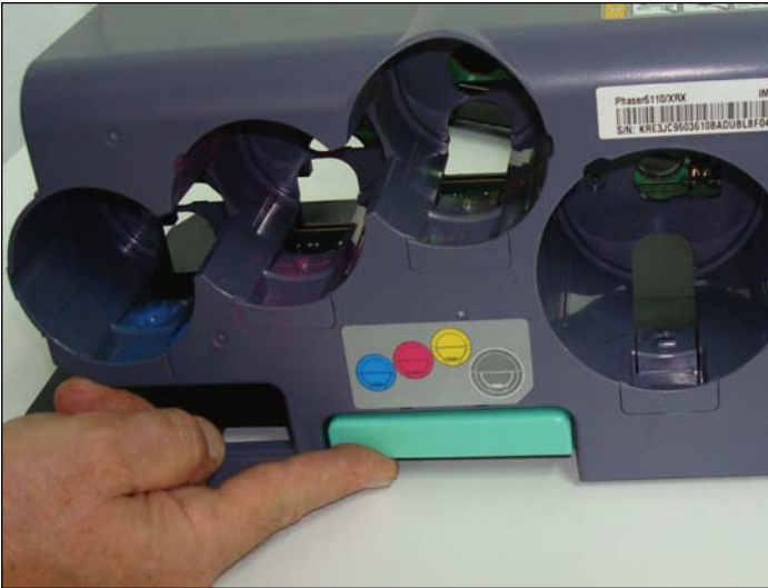
Ilustración 28. Alinear la manija antes del calce final de la Tapa.
