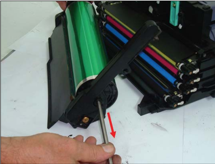
Ilustración 10. Retiro del eje del OPC.
